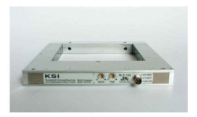
In den gegenüberliegenden Seitenschenkeln der Geräte befinden sich in geringen Abständen IR- Sender bzw. Empfänger, die im Durchtrittsbereich der Lichtschranke einen gleichmäßigen Lichtvorhang erzeugen.
